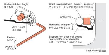
\*2 Use only the included 1.5mm hex wrench to adjust the set screw. セットねじを回すときは、必ず付属の1.5mmレンチをご使用ください。
