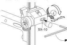
4 Coarse vertical adjustments can be made by loosening the B-2 Lock Down Knob, then pressing the SX-5 Release Lever, and sliding the aperture block up or down. B-2ストッパーを緩め、SX-5押しレバーを押しながらサイトボックス を上下に動かすと、サイトピンを大きく動かすことができます。
